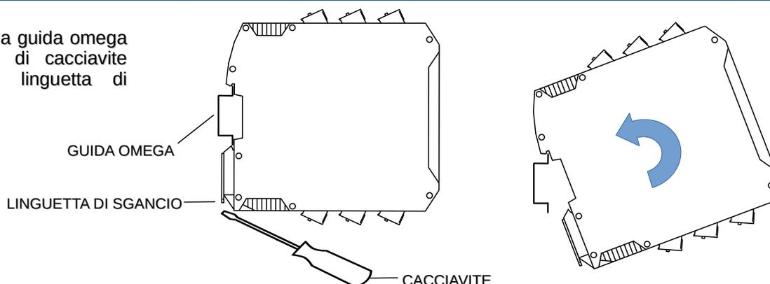
La CAB44V deve essere montata su guida omega standard in zona A d'immunità EMC. Non montare dispositivi generanti calore vicino ai moduli.
